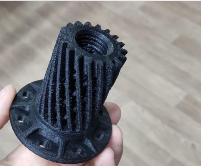
ФЛАНЕЦ РАСПЫЛИТЕЛЯ ДЛЯ МАЛОЙ АВИАЦИИ ИЗ ХИМИЧЕСКИ СТОЙКИХ ПОЛИМЕРОВ
