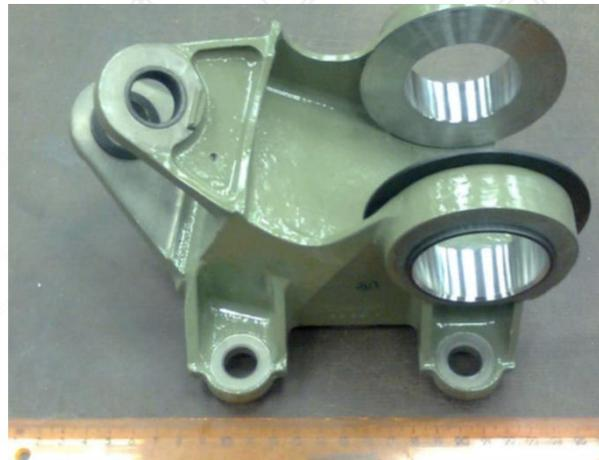
*Анализ наших возможностей для выращивания WAAM "Кронштейн 800.00.1925.0541 узла перекося лопасти»*
