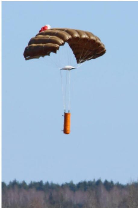
Контейнер предназначен для доставки и точного десантирования с воздушных судов средств спасения людей терпящих бедствие как на суше так и на воде.
