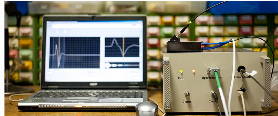
2 Количественная и качественная оценка несплошностей ПКМ при помощи ЛУИВ
