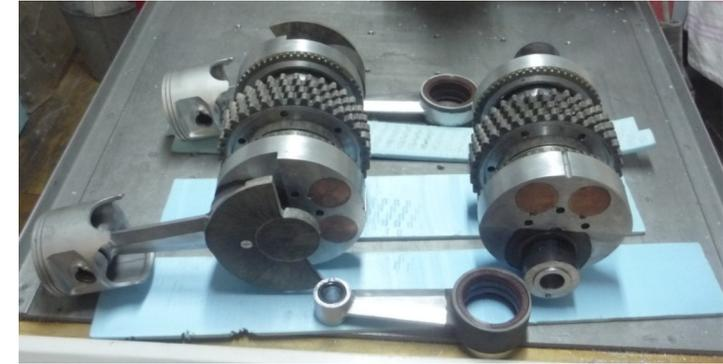
Детали двигателя в разобранном виде
