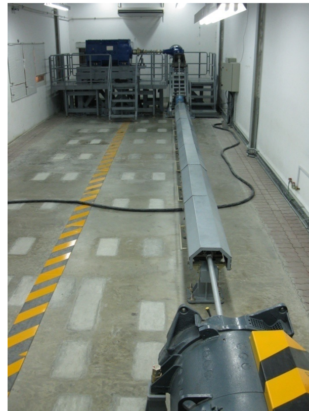
Стенды обкатки хвостовой трансмиссии вертолетов МИ-8 (ОАЭ)
