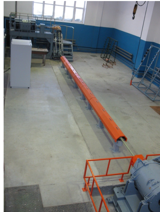
Стенды обкатки хвостовой трансмиссии вертолетов МИ-8 (НАРЗ)
