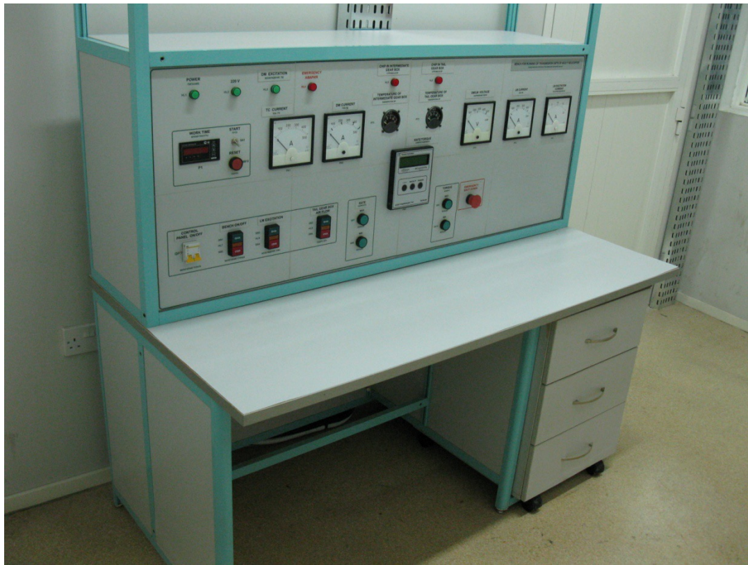
Стенды обкатки хвостовой трансмиссии вертолетов МИ-8 (ОАЭ)
