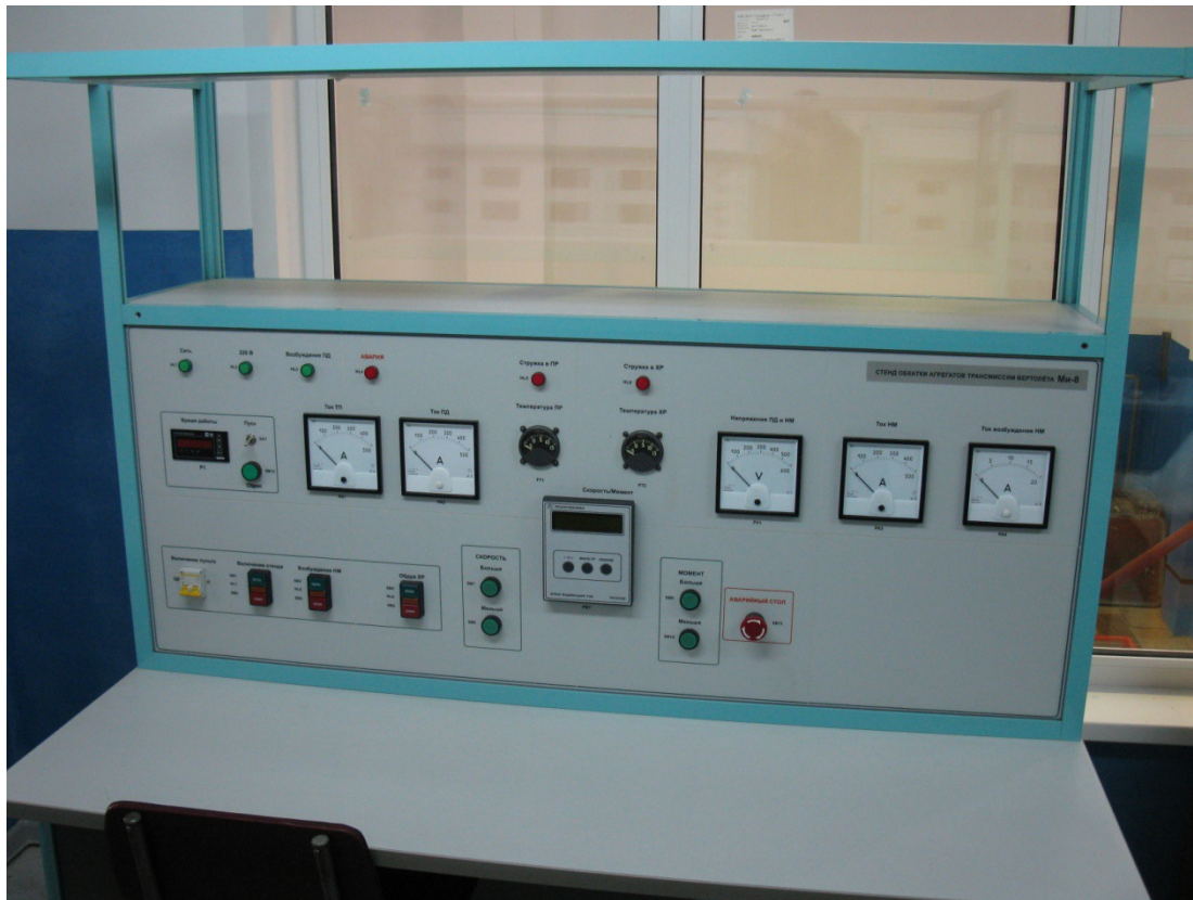
Стенды обкатки хвостовой трансмиссии вертолетов МИ-8 (НАРЗ)
