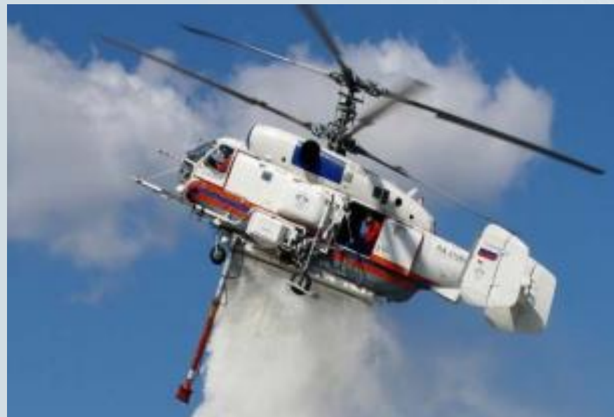
Рис.4 – Система горизонтального и вертикального пожаротушения «Симплекс-Ротекс»
