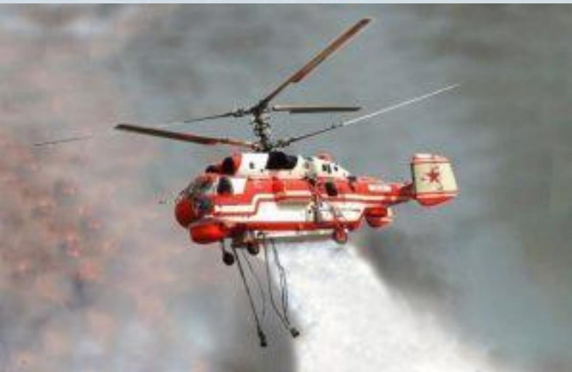
При удалении от места забора воды до расположения очага пожара в 5 км, вертолёт Ка-32 может ориентировочно перевезти и вылить за час 28 тонн воды
