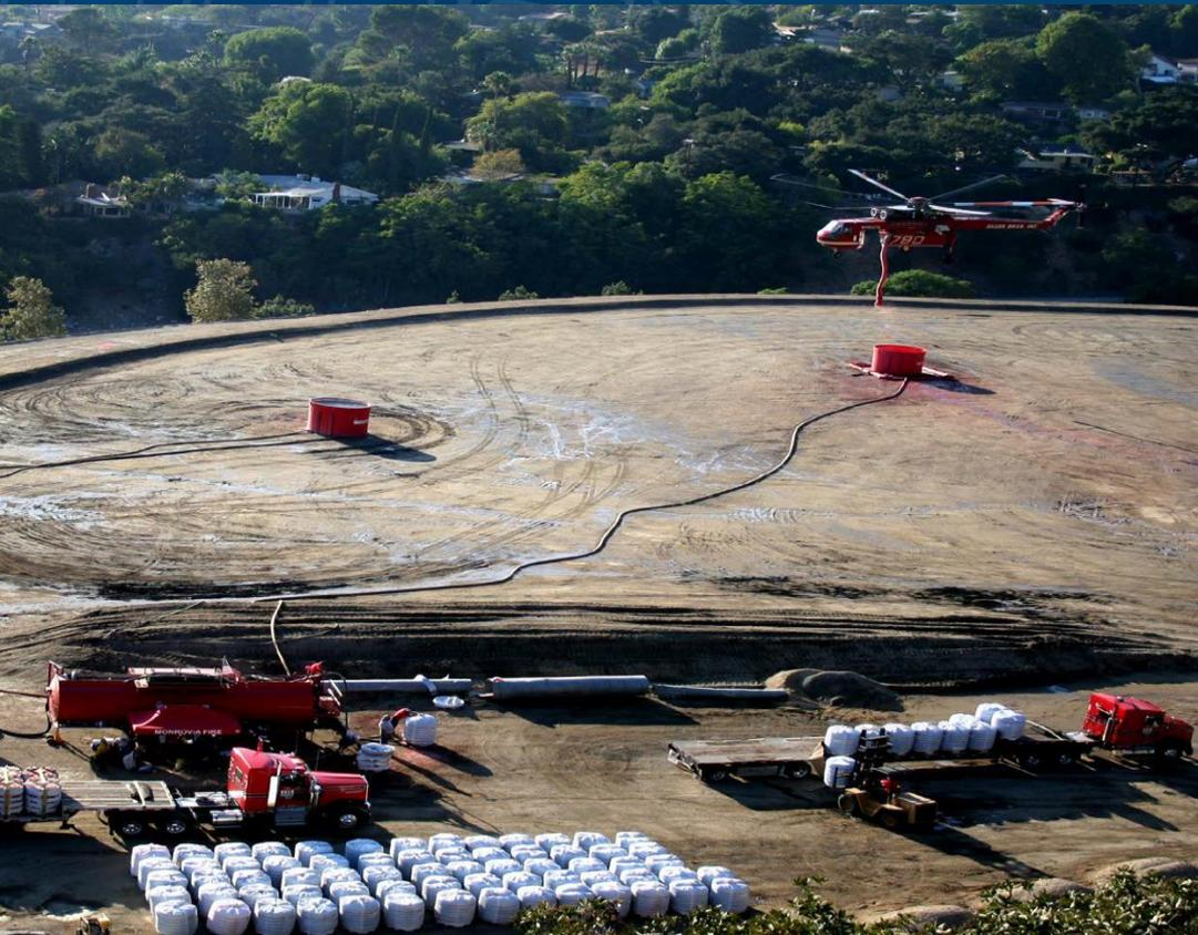
Растворный узел производства США PHOS-Chek, представляет собой рамный грузовик с полуприцепом-цистерной, оснащенной смешивающей установкой, схожей по типу с установкой приготовления буровых растворов из бентонита и воды.
