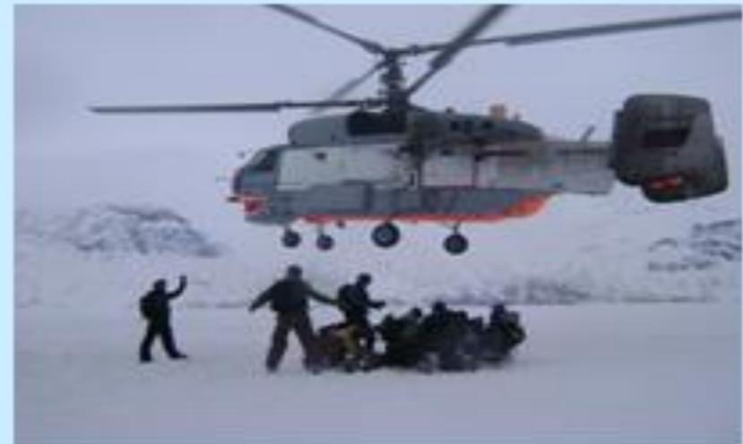
Вертолетная авиация в ходе проведения ПСР может работать с неподготовленных площадок. Преимуществом обладают вертолеты с соосной схемой винтов. При планировании спасательной операции необходимо учитывать, что во время приземления на неподготовленную площадку двигатели не выключаются.
