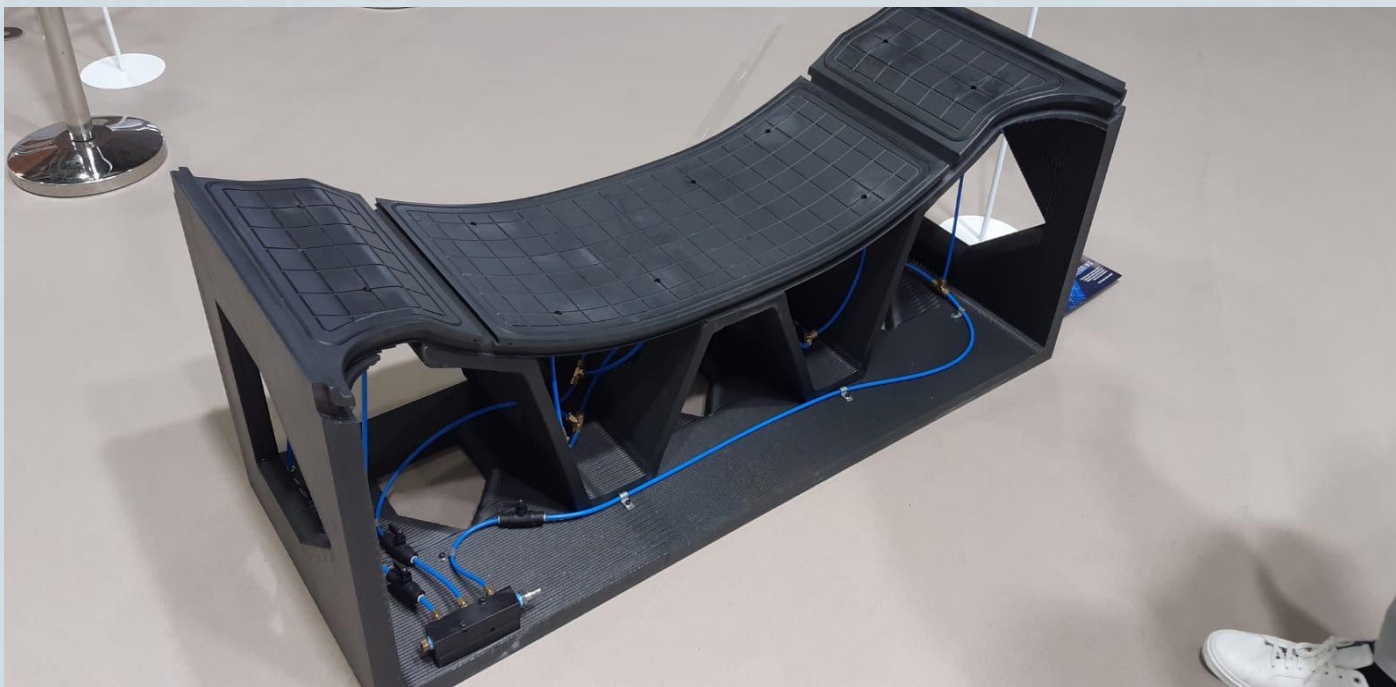
Пример готовой оснастки под вакуумную формовку
