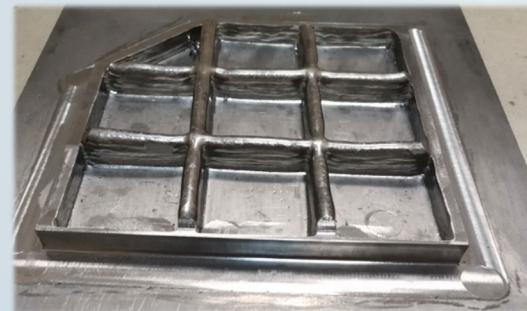
Фотография частично обработанного макета изделия «сотовая панель» (Материал – ВТ6ч)
