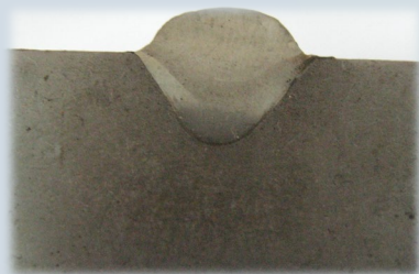
Макрошлиф наплавленного валика на токе прямой
