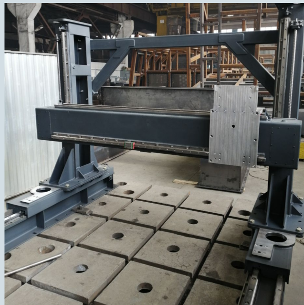
Пяти осевой аддитивный обрабатывающий центр (диаметр рабочей области до 1 метра)
