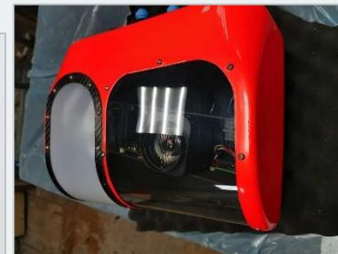
Примеры герметизированных (разные варианты корпусирования) трехосевых гиростабилизированных подвесов для БПЛА мультироторного типа. Видеокамера только оптического или +инфракрасного диапазонов
