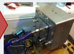
Постановка матрицы под давление Разогрев встроенными ТЭНами
