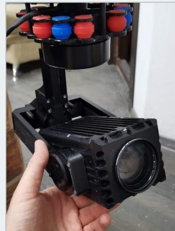
Пример разработки герметичного трехосевого гиростабилизированного подвеса с герметичным корпусом видеокамеры
