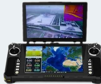
Интегрированная носимая НСУ с двумя сенсорными экранами
