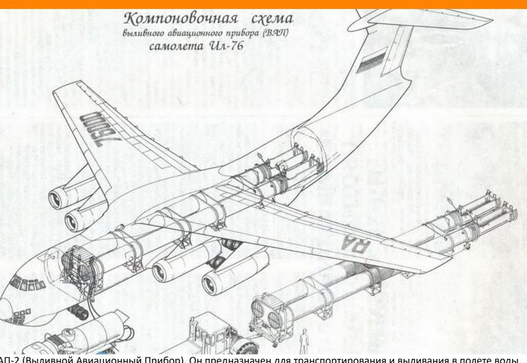
ВАП-2 (Выливной Авиационный Прибор). Он предназначен для транспортирования и выливания в полете воды, предназначенной для тушения пожаров. ВАП-2 состоит из двух жестко соединенных между собой контейнеров и устройств для заправки и сброса жидкости. Его конструкция позволяет вести заправку одновременно от нескольких пожарных машин или гидрантов.
