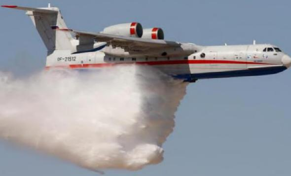
Может эксплуатироваться как с сухопутных аэродромов, так и с водоёмов при высоте волны до 1,2 метра. Фюзеляж самолёта герметичен, что позволяет быстро переоборудовать его для перевозки пассажиров или грузов, а также для выполнения ряда специальных операций
