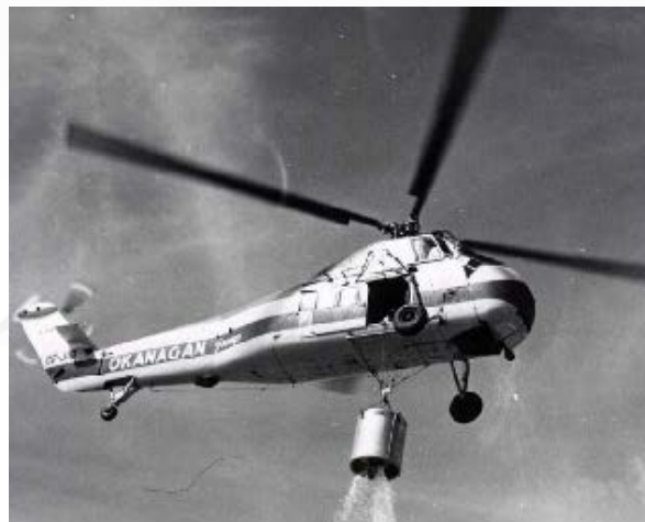
1958 год одно из первых экспериментальных водосливных устройств на вертолете Sikorsky S-58 (объем 1022 литра).
