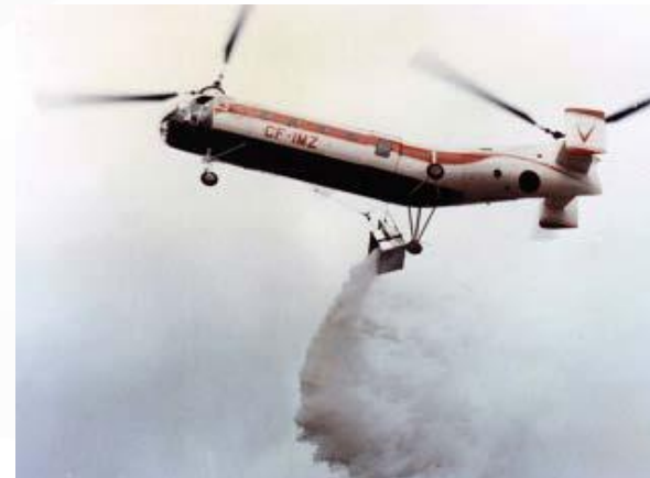
1961 год квадратное водосливное устройство на вертолете H-21 (объем 976 литра)
