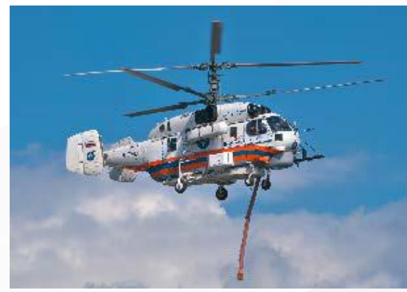
Ка-32А11ВС с системой Simplex328 и водяной пушкой
