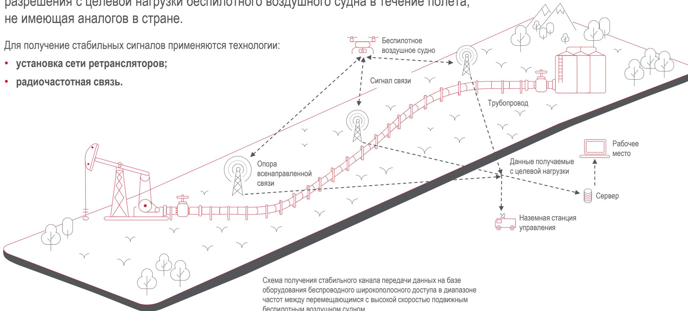
Схема получения стабильного канала передачи данных на базе оборудования беспроводного широкополосного доступа в диапазоне частот между перемещающимся с высокой скоростью подвижным беспилотным воздушным судном.
