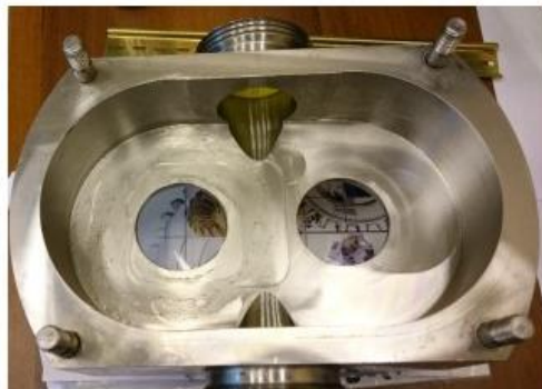
Корпус и ротор насоса перекачки молока, Ст 17X18Н9
