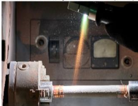
2. Лазерное сплавление с основой Ст40Х
