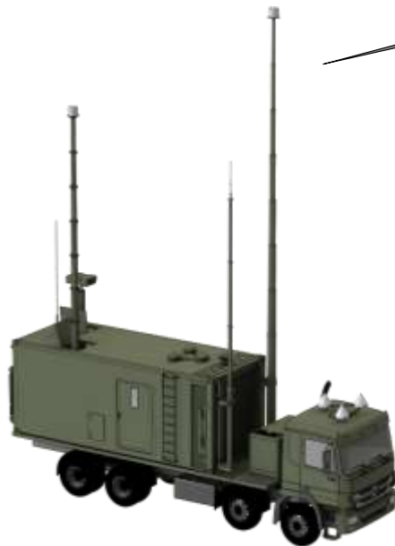
Мобильный пункт управления для выполнения оперативных
