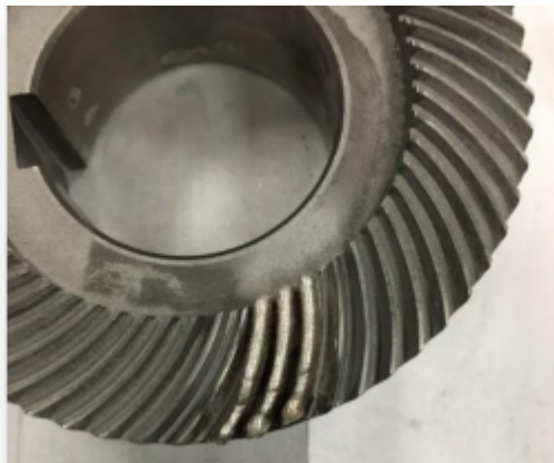
Пример восстановления изношенных зубьев колеса
