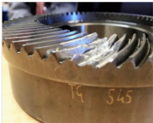
Пример восстановления изношенных зубьев колеса
