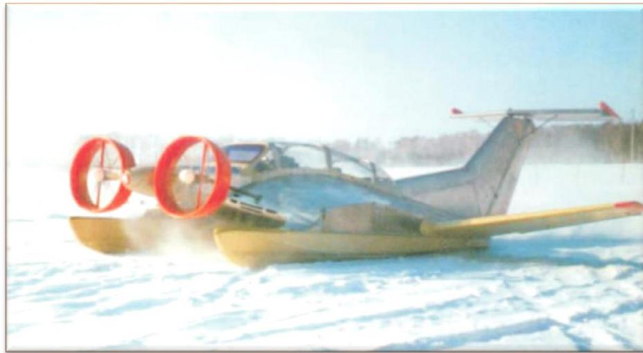
Экранопланы «Орион-12,-20» по классификации Международной морской организации (ИМО) соответствуют типу "В" и обладают уникальной возможностью использовать несколько режимов движения: полет, глиссирование, плавание, скольжение по льду и снегу, а также самостоятельно осуществлять спуск на воду и выход на берег (уклон 1:10). При этом, обеспечивается скорость движения в основном режиме «на экране» до 250 км/час и высокая маневренность.
