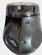
Гиростабилизированная платформа с FullHD-видеокамерой
