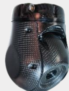
Гиростабилизированная платформа с тепловизором
